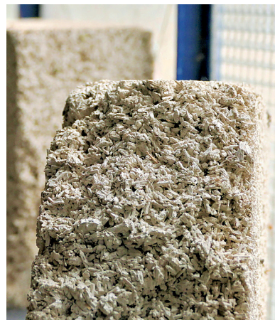
Ein Kalkhanfstein für den Bau.
